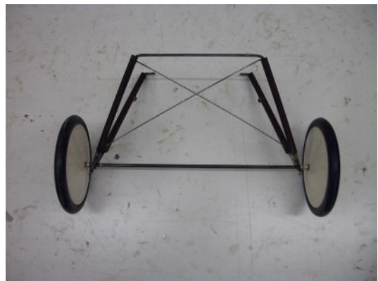
Das fertige Fahrwerk, Federung der Starrachse mittels Gummischnur
