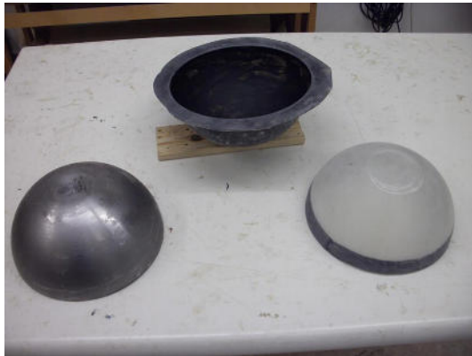
Spinnerherstellung: Eine IKEA-Salatschüssel dient als Urmodell (links), daraus wurde die Form gezogen (Mitte) und schlussendlich die Spinnerkappe (rechts) laminiert. Weitere Bearbeitung erforderlich!
