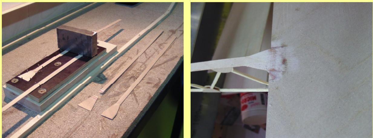
Diese werden mit Ausnahme des Wurzel- und Querruderbereichs aufgesetzt. An den Stößen zur Beplankung wird geschäftet.
