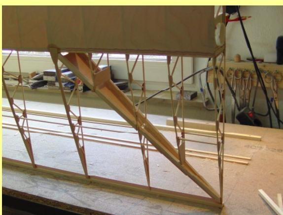
Ausarbeitung des Randbogens; alle Biegungen werden mit dünnen, aufeinander geklebten Kiefernleistchen realisiert.
