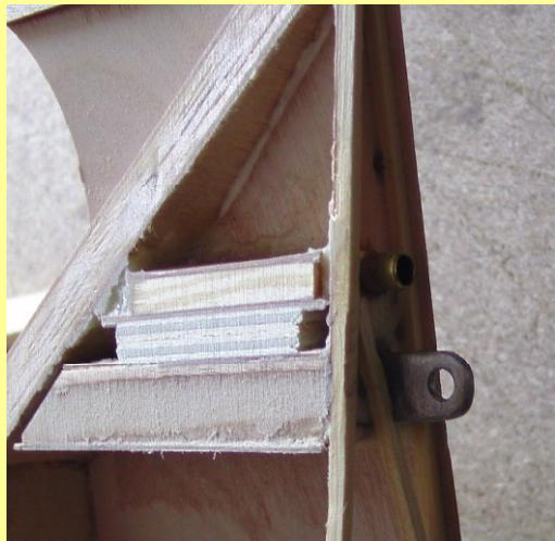
Beschläge werden aus 1-2mm VA-Stahl angefertigt und eingearbeitet. Schlussendlich wird das Flugzeug mit 4 Kippsen und einer Focka-Nadel aufgerüstet. Da ich oft schleppe, muss ich, wenn ich segeln will, meist zwei Flugzeuge aufrüsten. Das brauchte immer viel Zeit. Nun benötigt der Aufbau der Hütter nur noch fünf Minuten.
