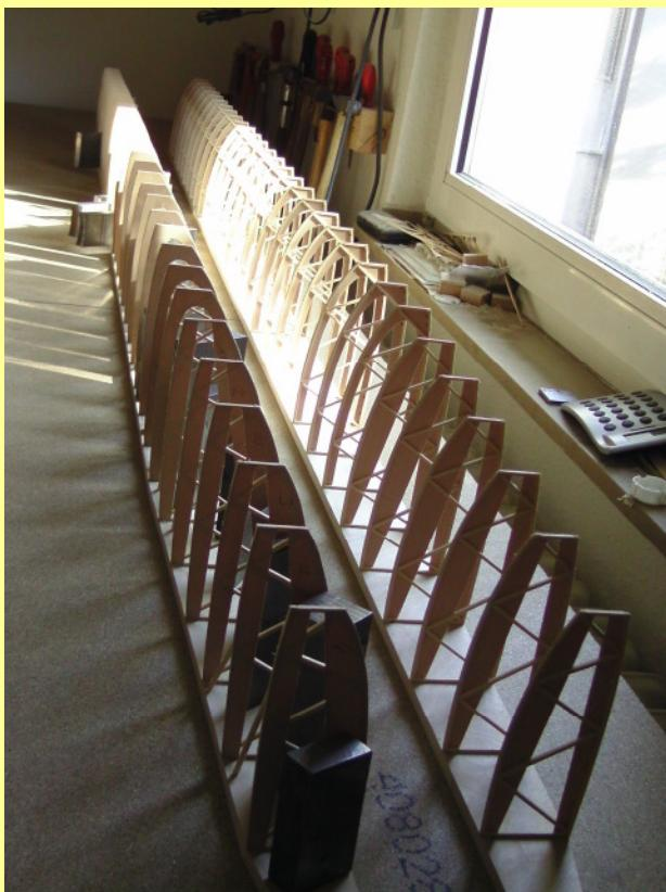
Um die Torsionskräfte bestmöglich aufnehmen zu können, besteht die Beplankung aus Birkensperrholz mit 45° Maserungsverlauf; 0,6 mm Stärke reichen völlig aus (die Hütter kommt bei kontinuierlich 60% steilem Herunterfliegen auf etwa 90 Kmh, vermutlich würde 0,4 mm Stärke auch reichen). Das Material wird segmentweise aufgesetzt; je drei Großrippenfelder bilden ein Segment. Alle Nahtstellen werden geschäftet.
