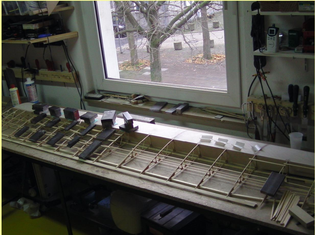
Parallel wurden 32 Rippenaufleimer mittels Vorrichtung vorgefertigt.
