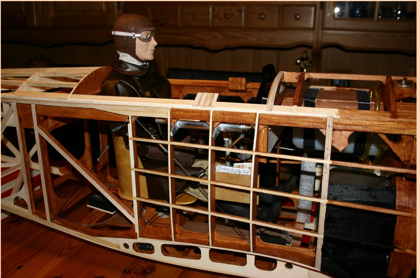
Der Pilot natürlich ein waschechter Engländer (Fa. Reeves) und durfte probeweise Platz nehmen. Unten sind auch der verbaute Schalldämpfer sowie der Tank zu erkennen.
