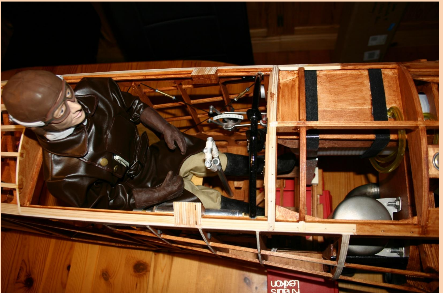
Der Pilot natürlich ein waschechter Engländer (Fa. Reeves) und durfte probeweise Platz nehmen. Unten sind auch der verbaute Schalldämpfer sowie der Tank zu erkennen.
