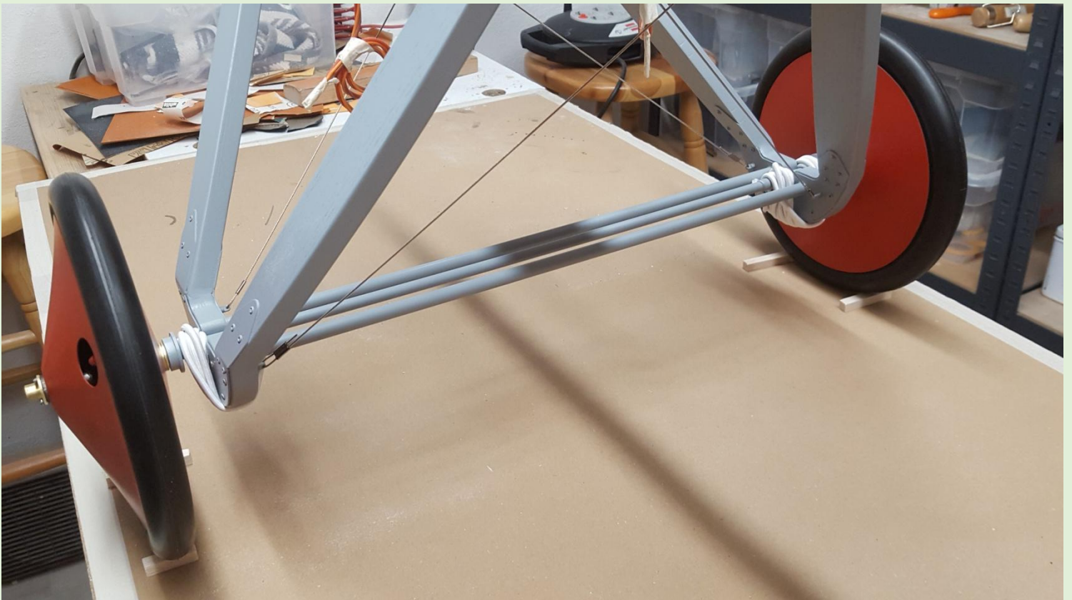
Die Achse besteht aus Federstahl und ist durch Gummischnüre gefedert.
