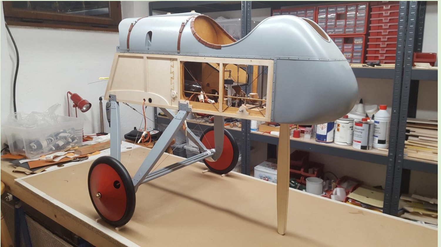
Die Achse besteht aus Federstahl und ist durch Gummischnüre gefedert.
