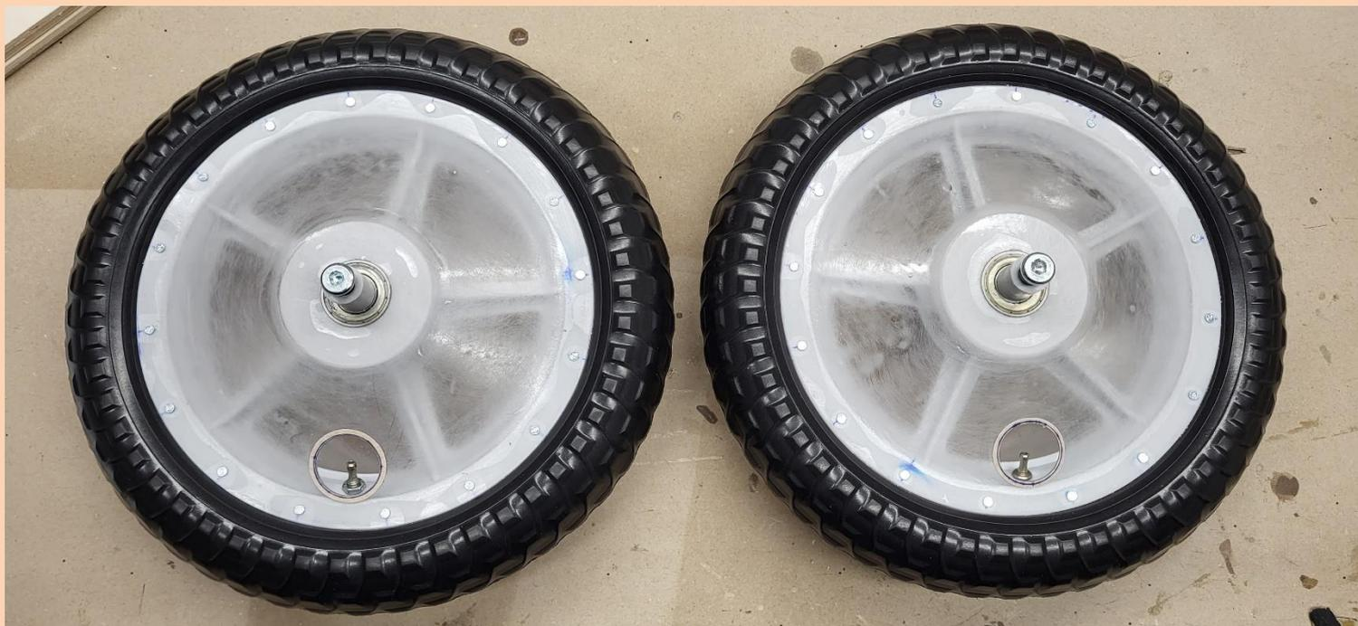
Ein Blick auf die Räder (bereits mit angepassten Radkappen aus dem Baukasten und selbst improvisierten Ventilen)
