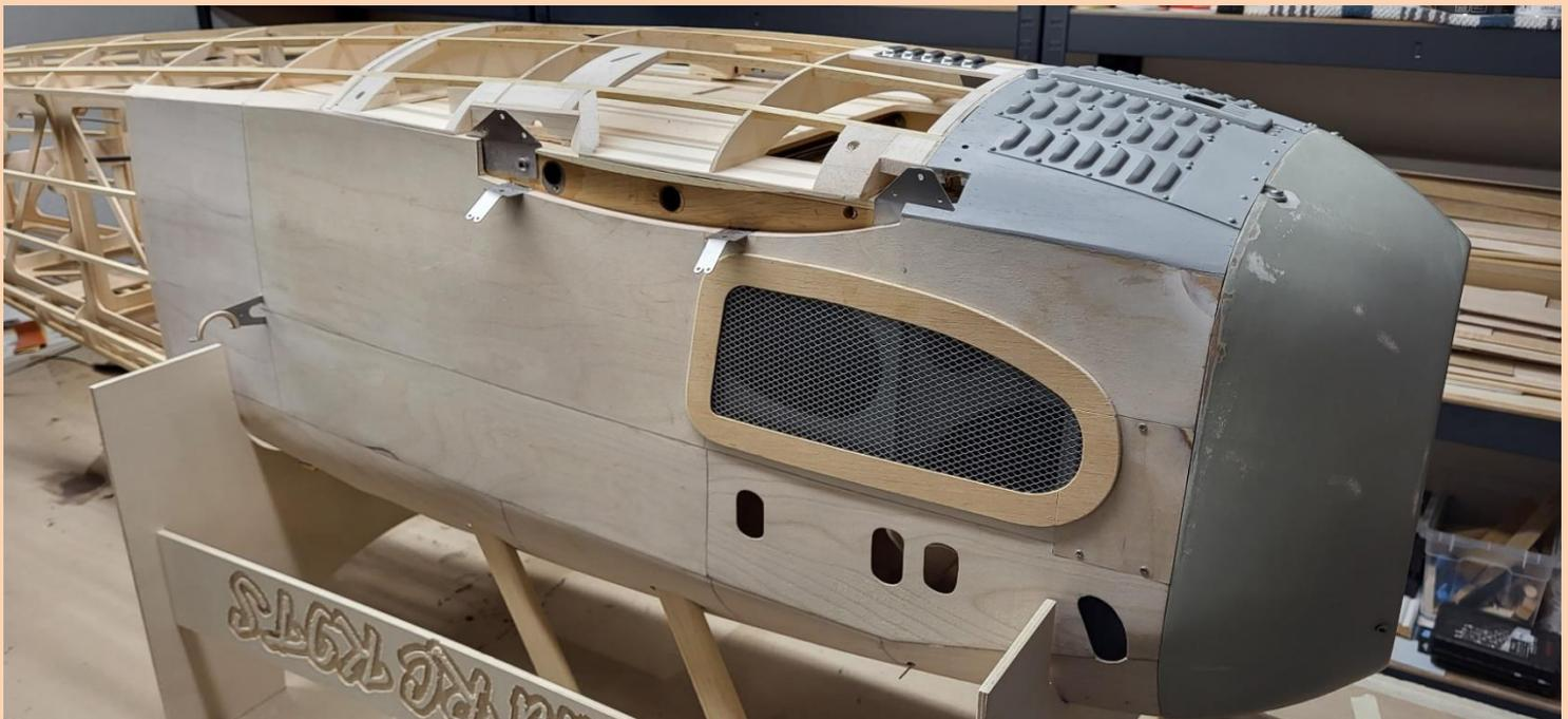
Mit einigen weiteren Details versehen (Nieten, vordere Baldachinstreben angepasst, seitliche Munitionsklappen und Auswurfschächte für die leeren Patronenhüllen), grundiert und geschliffen:
